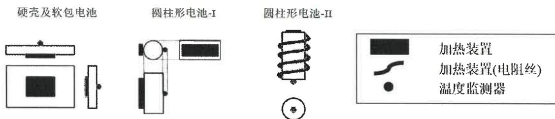
热失控试验加热示意图
